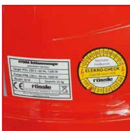
Elektrische Prüfung nach DIN
