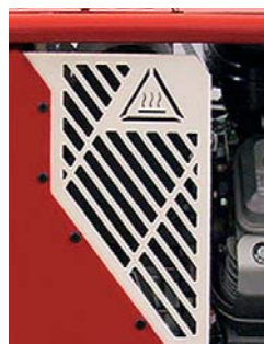
Berührungsschutz Auspuff optimale Abluft
