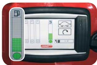
Ablesen des Tankfüllstandes im Stillstand möglich
